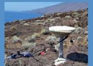
Red Geodésica GNSS-GPS establecida en la isla de El Hierro y vértice geodésico H110
